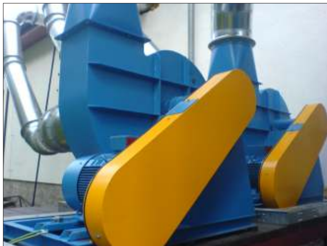
• Odsávací ventilátory typu VSR instalované ve firmě SWN (Mladoovice, R)
